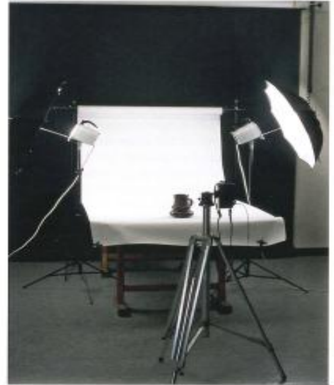
Abb. 9: Ein provisorisch aufgebauter, aber durchaus geeigneter Aufnahmetisch. Die Beleuchtung erfolgt hier über zwei Blitzlampen mit Reflektorschirmen.
